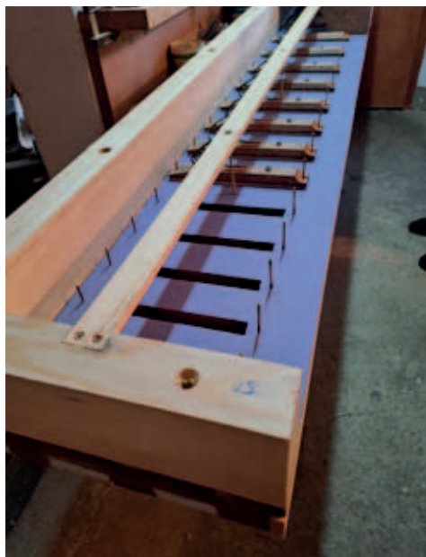
Fot. 18. Naprawiona wiatrownica pedału (fot. Tomasz Sowiński)
