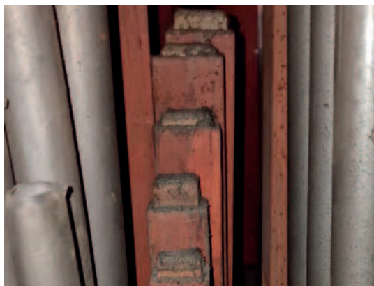
Fot. 60. Szpunty na piszczalkach drewnianych
