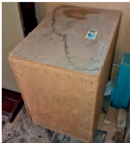
Fot. 3. Obudowa dmuchawy
