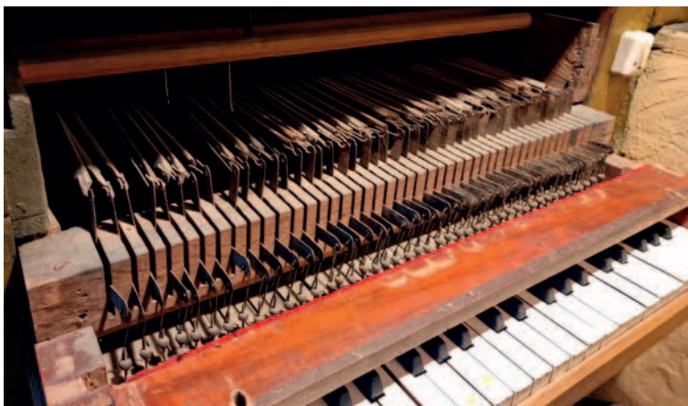
Fot. 23. Fragment traktury od strony klawiatury instrumentu
