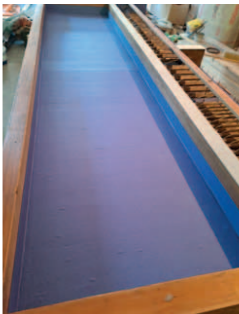
Fot. 16. Wklejony nowy papier i kłapy zaworów po renowacji (fot. Tomasz Sowiński)
