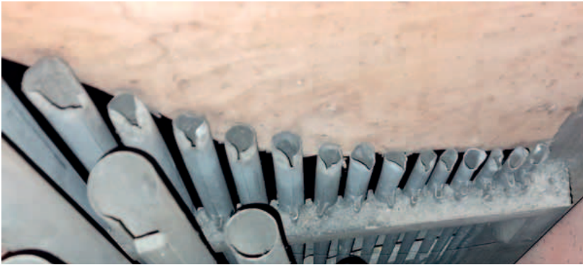
Fot. 31. Fragment głosu prospektowego z widocznymi rozerwanymi fragmentami korpusów piszczałek
