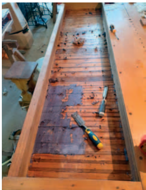
Fot. 15. Czyszczenie wiatrownicy manualu (fot. Tomasz Sowiński)
