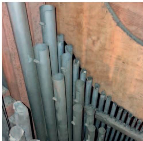
Fot. 33. Metalowe piszczałki głosu Contr Pryncypał 8'
