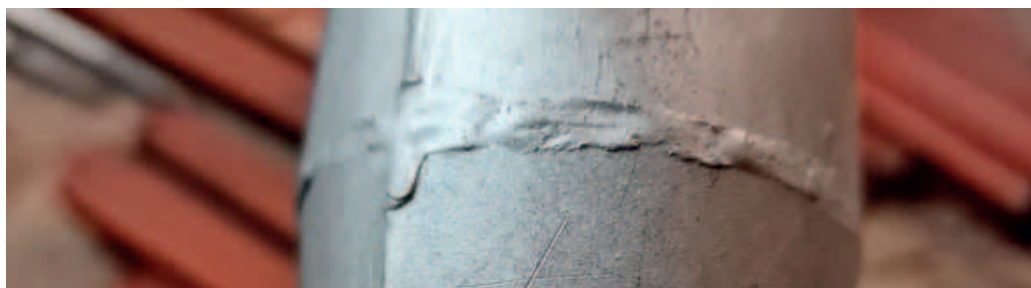
Fot. 55. Zbliżenie na luty w piszczałce oryginalnego głosu
