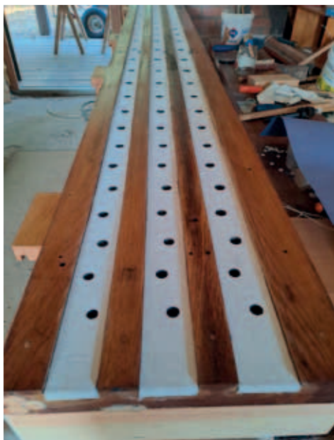
Fot. 19. Wiatrownica pedału z nowymi okleinami (fot. Tomasz Sowiński)
