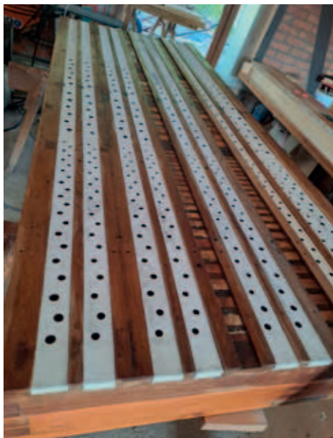
Fot. 17. Nowe okleiny zasuw rejestrowych (fot. Tomasz Sowiński)
