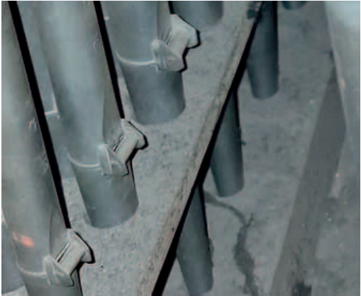
Fot. 42. Labia metalowych piszczałek głosu Viola di Gamba 8
