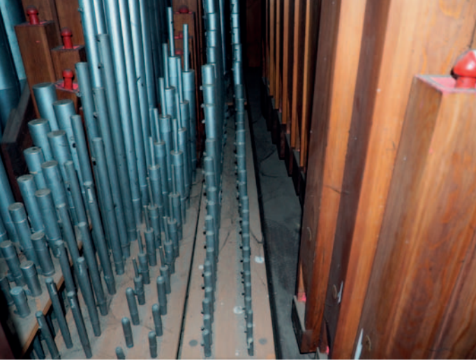
Fot. 5. Piszczalki na wiatrownicy stożkowej organów w kościele w Chojnem (fot. Mariusz Wiktorowski)
